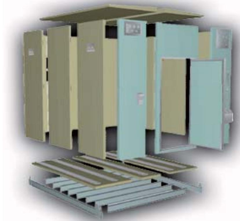
本組合機櫃6面的板材均為複合式結構，其內、外雙層皆為 PVC 披覆處理之鍍鋅鋼板，中間層填充(聚氨酯)PU，並預埋C型鋼為結構之一部份，其目的除了加強板材之硬度外，亦可附掛做固定使用。
